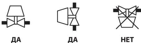
Рис. 3. Рекомендации по ориентации крана в пространстве.
